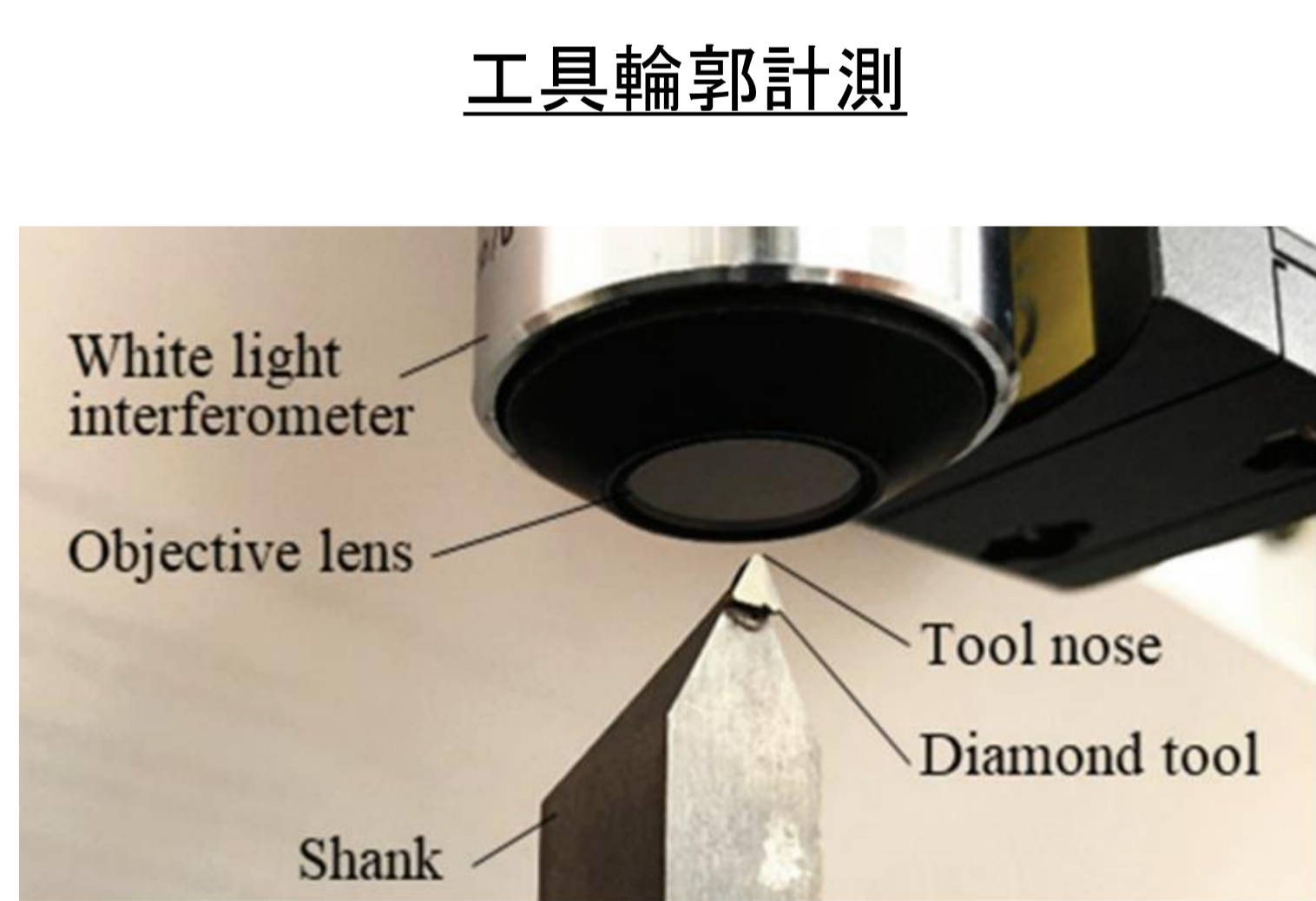
白色干渉計による工具形状の計測
