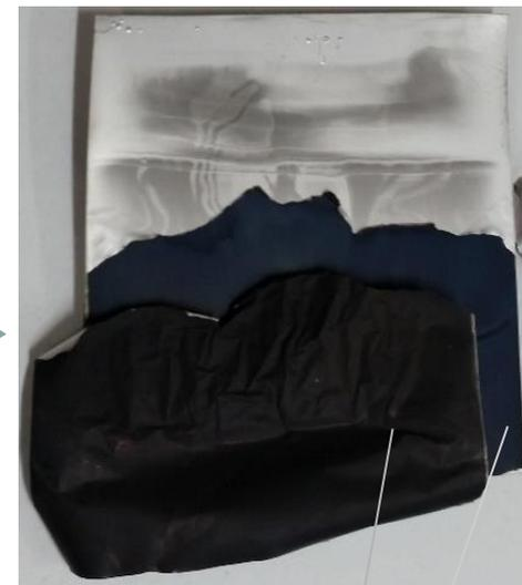
元の基板上と剥離物の両面に黒色膜が形成
