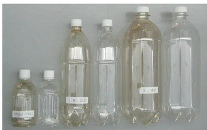
DLC 薄膜を被覆したペットボトル
