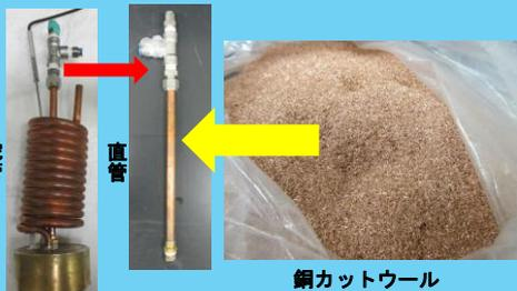
銅製蛇管の冷却管で大部分のVOCCを冷却凝縮した後、銅カットウールを充填した直管で希薄濃度VOCCを凝縮する
