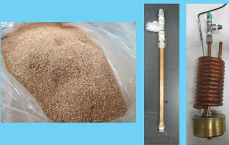
蛇管で大部分の VOCC を冷却凝縮し
