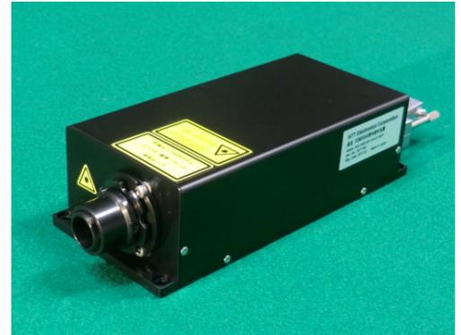
NTTエレクトロニクス社と共同でメタン同位体比測定装置(試作機)を開発しました。新規開発の $3\mu\text{m}$ 帯2波長出力中赤外光源は、非線形効果の一つである差周波発生を利用し、 $^{12}\text{CH}_4$ 測定用、 $^{13}\text{CH}_4$ 測定用に $3\mu\text{m}$ 帯2波長を同一光軸線に出力します。
