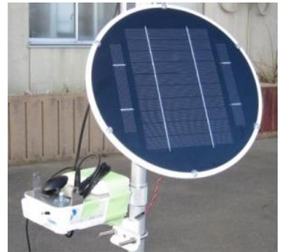
試作中の太陽電池と無線機式放射線センサ
