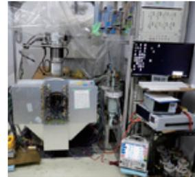
PEFCを計測するためのNMR計測装置
