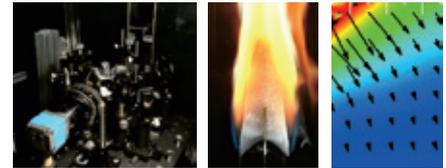
燃焼時の可燃性固体 (プラスチック) 内部非接触温度測定 (左: 測定装置, 中央: 燃焼時写真, 右: 内部温度分布)
