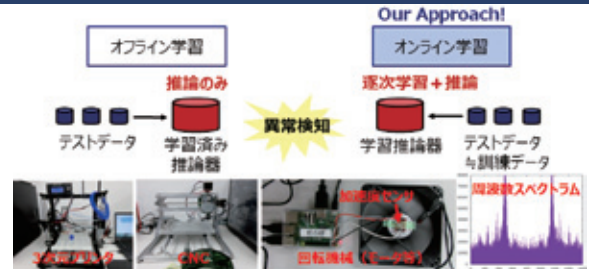
図1 オンライン逐次学習による教師なし異常検知技術 Fig.1 Online sequential learning and unsupervised anomaly detection
