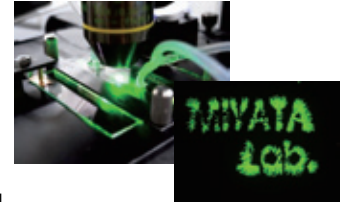
創薬スクリーニングのための細胞チップ (左) と異種細胞のアセンブリ (右)
