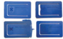
成形不良の自動認識と 最適成形条件自動決定
