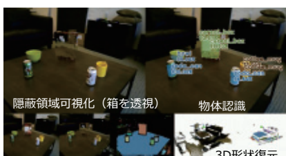
移動手持ちカメラ画像列からの3D形状復元と 物体認識の同時実行とそれに基づく隠蔽領域可視化
