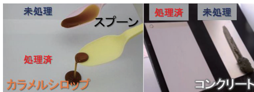
高粘性液体の滑落コーティング： カラメルシロップ(左)、コンクリート(右)
