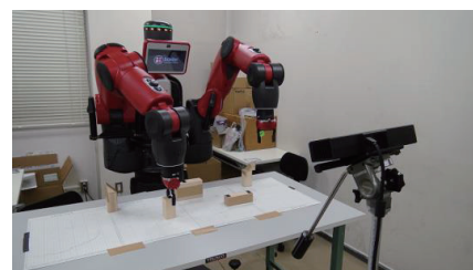
積み木の組立作業を自律的に改善するロボット
