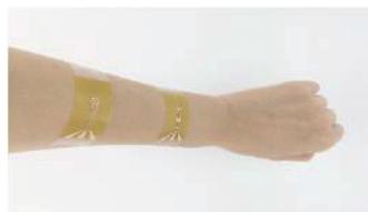
触覚呈示装置。体の様々な箇所に貼り付けられます。
