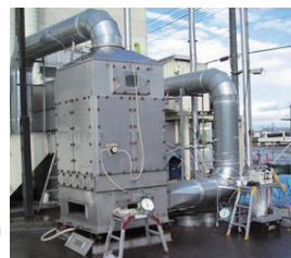
大型多孔質PTFE膜パネルを用いた排気ガス中VOC除去処理実験装置
