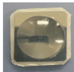
複合フレネルレンズとそれによる暗視野像
