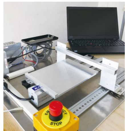
新開発されたUV防御効果測定用塗工装置
