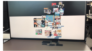
図6. 直交配置マルチディスプレイによる裸眼立体視を適用したTubeView
