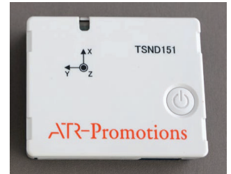
図1. 慣性センサ (40 mm × 50 mm × 14 mm)
