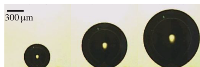
ガス過飽和水中におけるガラス付着気泡の成長
