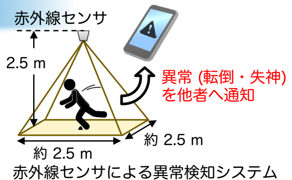
8×8 Panasonic Grid-EYE (天井設置時)
