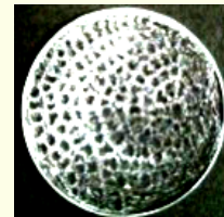
オレンジピール(ユズ肌)模様が発生した乾燥面 ポリマー溶液の液膜から溶媒が揮発する際の自発的な対流パターンの発生
