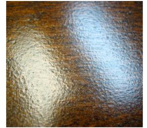
図 塗装面に発生するオレンジピール(ゆず肌)
