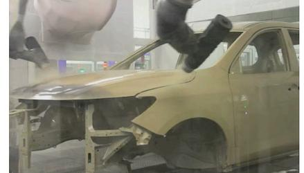
塗装機先端のベルカップを開発、これを利用した塗装法で能力が向上し、塗装機基数の半減(40→20台)と、CO<sub>2</sub>排出量の20%削減が実現、インド、中国、アメリカ、メキシコ、ブラジルの工場にて、
