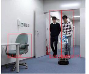
開発中の画像認識モジュールによる認識結果例
