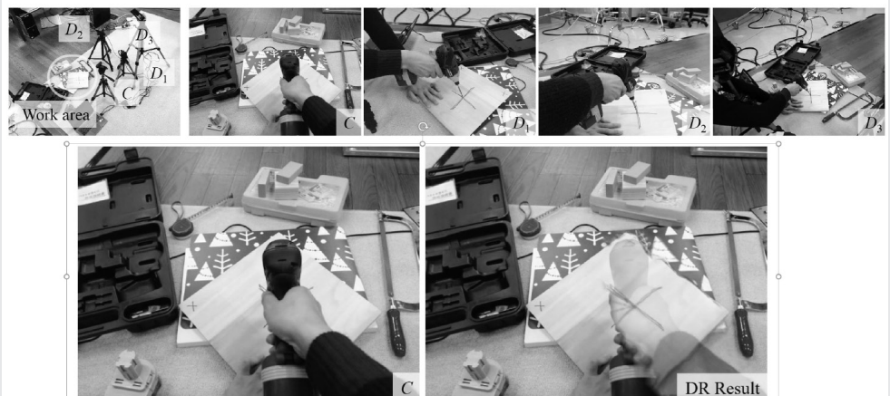
図6 上段に示した多視点画像から、下段右のようにドリルと手を透視可能な画像を生成している例
