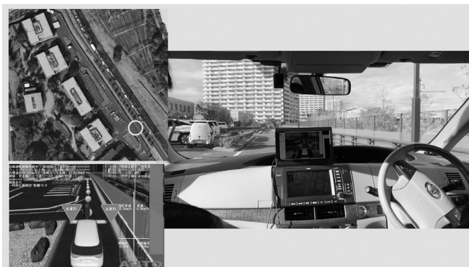
慶應キャンパスでの自動運転実験 左上：車両位置、左下：サイバー上での走行目標、右：実車
