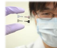
電気化学発光を利用した酸素センサ(左)とフィルム化の検討(右)
