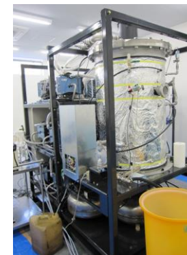
空気流動真空蒸発法による廃溶剤再生装置
